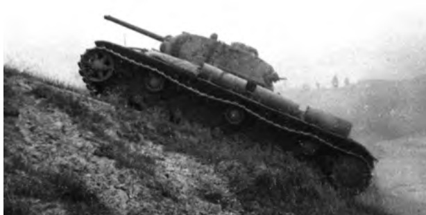
Танк КВ-1С выпуска апреля 1943 года преодолевает подъем в 26 градусов во время испытаний машины на гарантийный километр. Май 1943 года.
