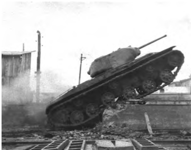
Испытания одного из первых серийных танков КВ-1С в августе — сентябре 1942 года. Машина преодолевает бетонную стенку.
