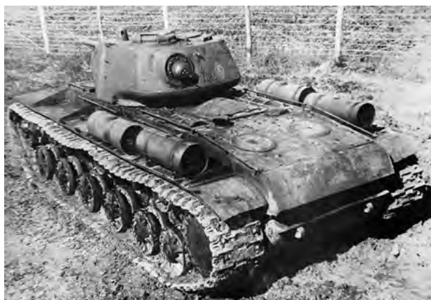
Танк КВ-1С выпуска августа 1943 года, вид сзади сверху. Снимок сделан на НИБТ полигоне после проведения испытаний на гарантийный километраж. Белый ромб на башне с цифрой внутри — обозначение машин НИБТ полигона.
